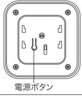
本体の電源OFFにすることで警報音の鳴動が停止します。
