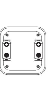
新しいリチウム電池2本(CR123A)を、極性が正しくなるように取り付けてください。(スプリング端子側が+極です)
