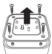
背面カバー固定ビス(4カ所)を取り外し、カバーを取り外してください。
