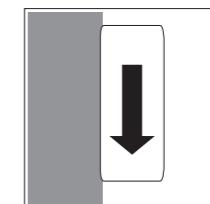
本体固定用フック穴にブラケットのフックを差し込み、カチッと音がするまで本体を押し下げて固定してください。
