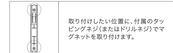
取り付けしたい位置に、付属のタッピングネジ(またはドリルネジ)でマグネットを取り付けます。
