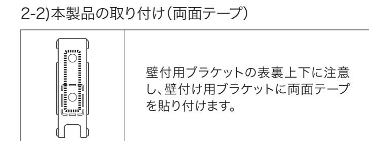
壁付用ブラケットの表裏上下に注意し、壁付け用ブラケットに両面テープを貼り付けます。
