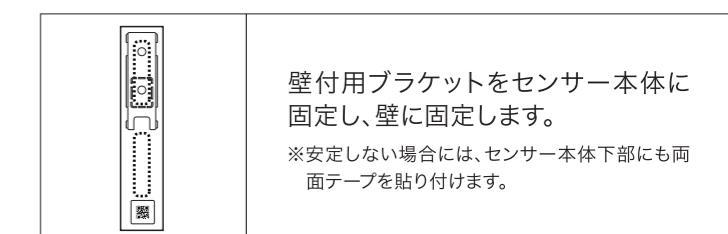
壁付用ブラケットをセンサー本体に固定し、壁に固定します。
