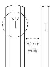
センサー本体とマグネットを、所定の位置(20mm以内)まで接近させると、本体のLEDインジケーターが点灯します。
